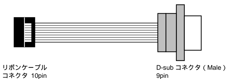
Fig 3.8-2 D-Sub 変換ケーブル配線仕様
