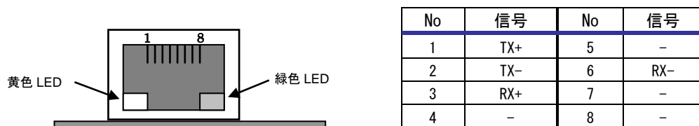
Fig 3.3-2 LAN ポートコネクタ (P1 正面)
