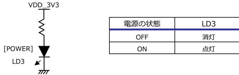
Fig 2.5-3 電源 LED 回路構成
