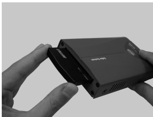
図3. 3-4 無線LANカード挿入完了
