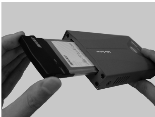
図3. 3-3 無線LANカード挿入方向
