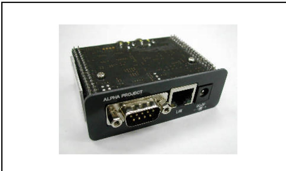
Fig 5.2-9 背面パネルの取り付け
