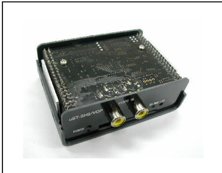
Fig 5.2-12 下カバーの取り付け
