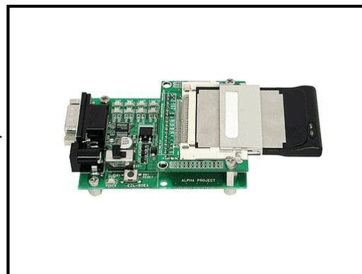
①無線LANカードの上面を上にしてEZL-80Cに挿入して下さい。(図4. 3-3)
