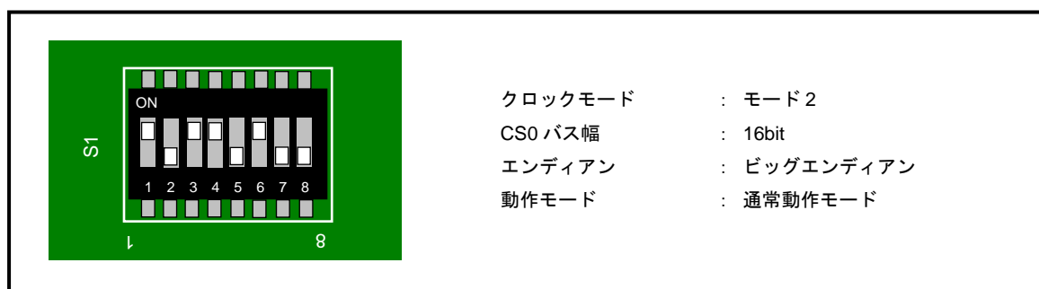
Fig1.2-2 動作確認時の動作モード設定
