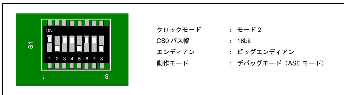
Fig1.2-1 ビッグエンディアン時の動作モード設定
