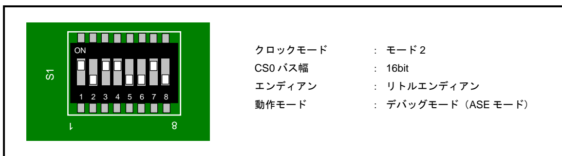
Fig1.2-2 リトルエンディアン時の動作モード設定
